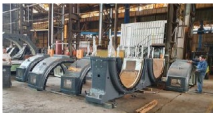
Элементы подшипников цапф/ их модернизация
